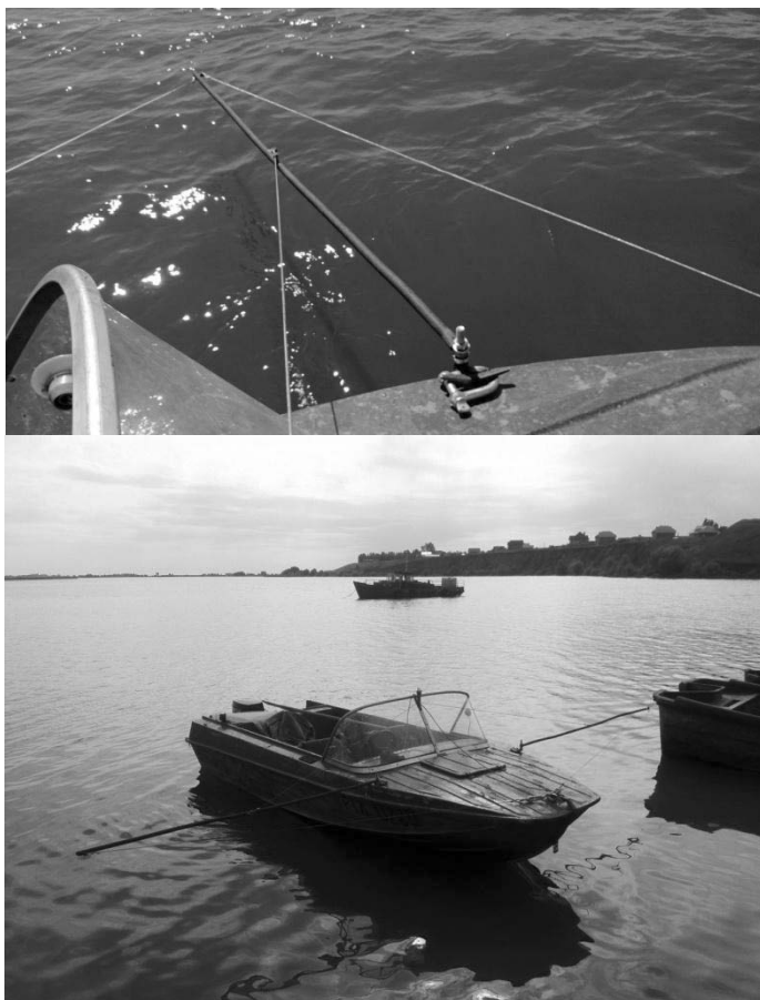
Рис. 1. Лодка с распорной балкой оснащенной системой тросов
